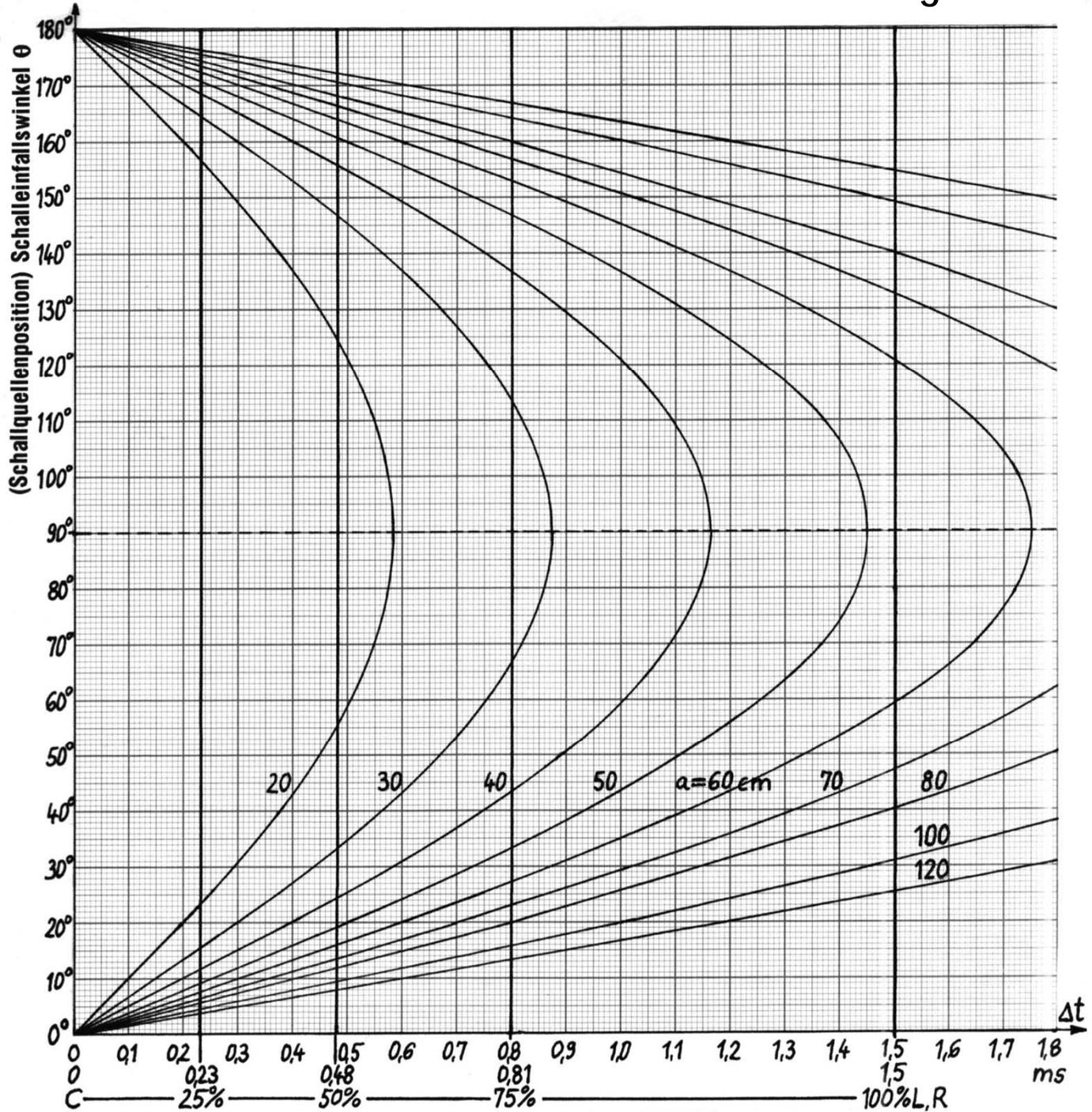
Höreignisrichtung auf der Lautsprecherbasis bzw. Laufzeitdifferenz  $\Delta t$  in Abhängigkeit vom Schalleinfallswinkel  $\theta$  auf das Mikrofonsystem. Mikrofonbasis  $a$  als Parameter.
