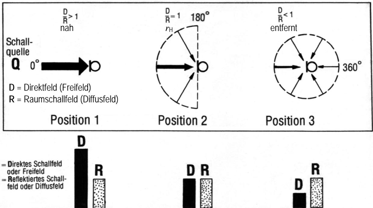
Bei **Position 1** ist das **nah** an der Schallquelle positionierte Mikrofon überwiegend dem direkten Schallfeld D ausgesetzt.  $D > R$ . Der Schalleinfall wird hauptsächlich von vorn in der Mikrofonhauptachse erfolgen; d. h. der Frequenzgang muss nur für den 0°-Bereich gerade sein. D = Direktfeld und R = Raumschallfeld.
