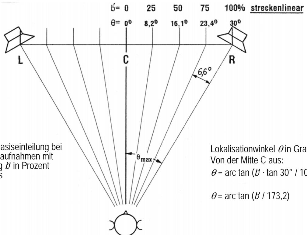
**Streckenlineare** Basiseinteilung bei praktischen Stereoaufnahmen mit Hörereignisrichtung  $b'$  in Prozent von der Mitte C aus
