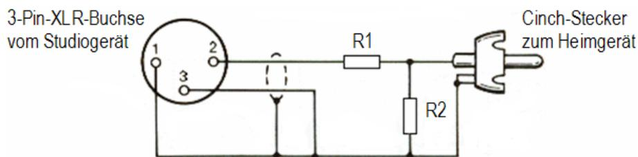
Wie müssen die Widerstände angeordnet sein, wenn man den Adapter als 12-dB-Spannungsteiler von einem XLR-Ausgang auf einen symmetrischen XLR-Eingang haben möchte?
