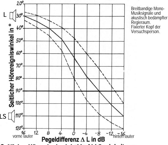
Seitlicher Hörereigniswinkel in Abhängigkeit von der Pegeldifferenz der Interchannel-Signale
