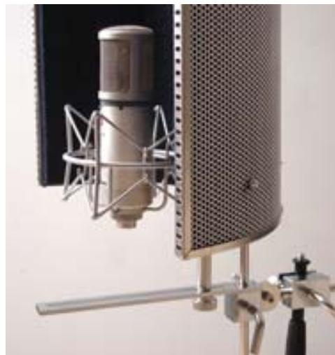
Die mitgelieferte Stativhalterung enthält eine Schiene, auf der sowohl das Mikrofon (in seiner Spinne), als auch das Reflexion Filter befestigt werden. Mikrofon und Filter können damit vertikal und horizontal zueinander ausgerichtet werden, bis eine akustisch optimale Position gefunden wurde.
