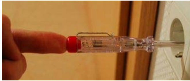
Phasenprüfer im Einsatz. Die Glimmlampe leuchtet nur leicht.
