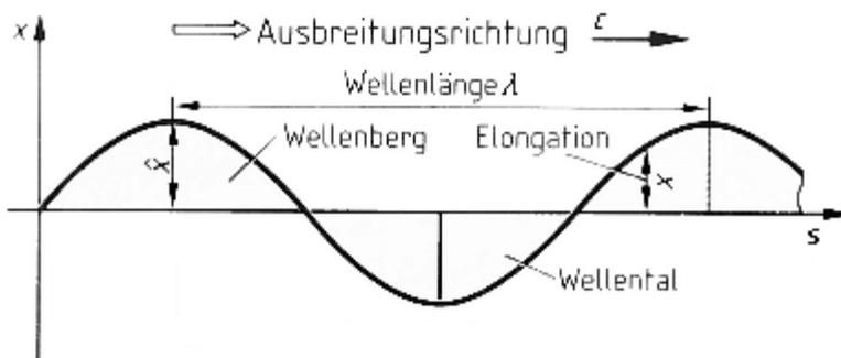
4. An der waagerechten x-Achse steht die **Zeit t** angeschrieben. Wie wird der Abstand von Wellenbauch zu Wellenbauch genannt? Schreiben Sie das Wort auf die Pfeillinie.
