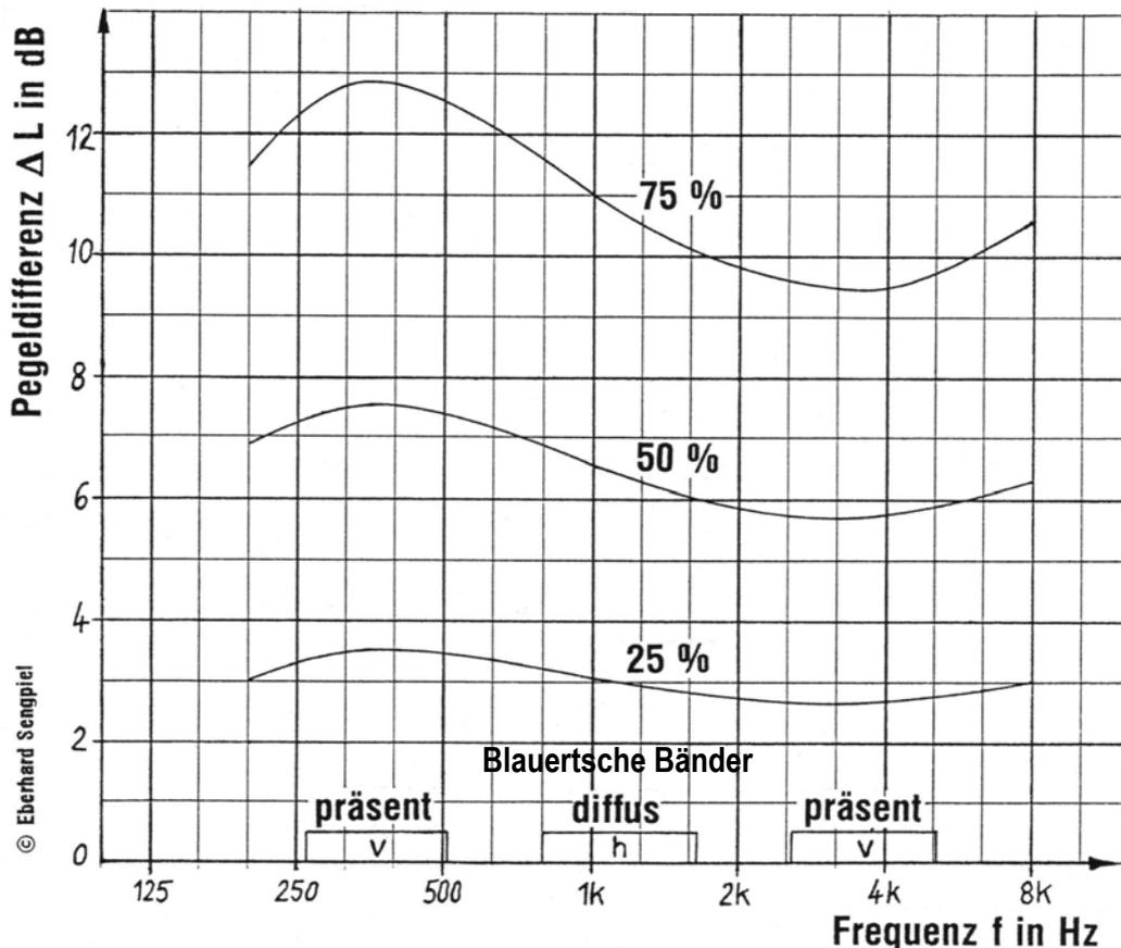
**Pegeldifferenz  $\Delta L$  in Abhängigkeit von der Frequenz  $f$  bei schmalbandigen Interchannel-Signalen. Parameter ist die Haupt-Hörereignisrichtung  $b = 25\%$ ,  $50\%$  und  $75\%$ .**
