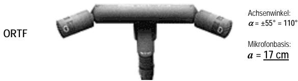
Diese Mikrofonanordnung stellt die frequenzneutralen Interchannel-Pegeldifferenzen  $\Delta L$  und die notwendigen Laufzeitdifferenzen  $\Delta t$  her, die für die Lautsprecher-Stereofonie zur Abbildung der Hörereignisrichtungen auf der Lautsprecherbasis benötigt werden und die den festen Aufnahmebereich von etwa  $\pm 48^{\circ} = 96^{\circ}$  ergeben.
