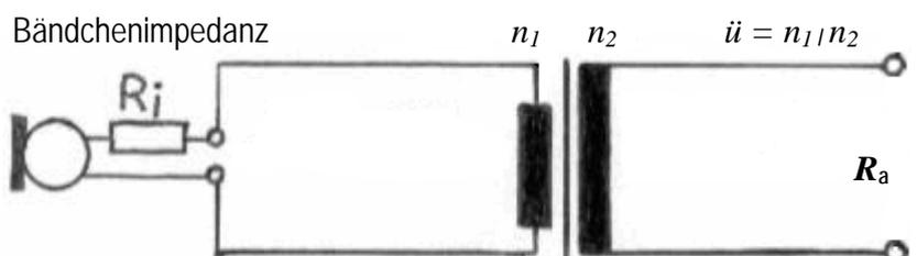
Wenn beim Übertrager im Bändchenmikrofon  $\ddot{u} = n_1/n_2 = 1 : 30$  ist, dann ist bei  $R_1 (R_i) = 0,2$  Ohm Bändchenwiderstand der **Ausgangswiderstand des Mikrofons  $R_2 (R_a) = 0,2 / (1/30)^2 = 0,2 \cdot 900 = 180$  Ohm**. Dieser Widerstand ergibt sich notwendigerweise - aber die Audiospannung wird hiermit um das 30-fache angehoben.
